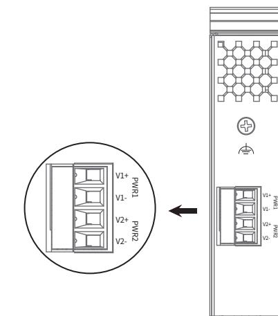
1. 将负/正DC线插入接线端子的V-/V+端子。
