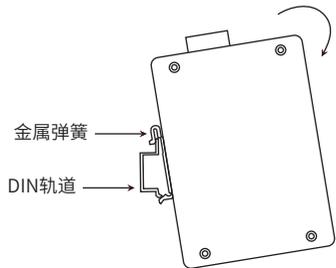
2. 将交换机迅速旋转按入DIN导轨, 如下图所示位置。
