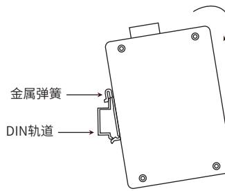
2. 将交换机迅速旋转按入DIN导轨, 如下图所示位置。
