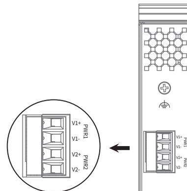
1. 将负/正DC线插入接线端子的V-/V+端子。
